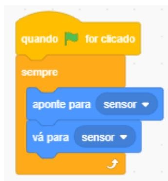
Figura 9: comando para orientação do robô
