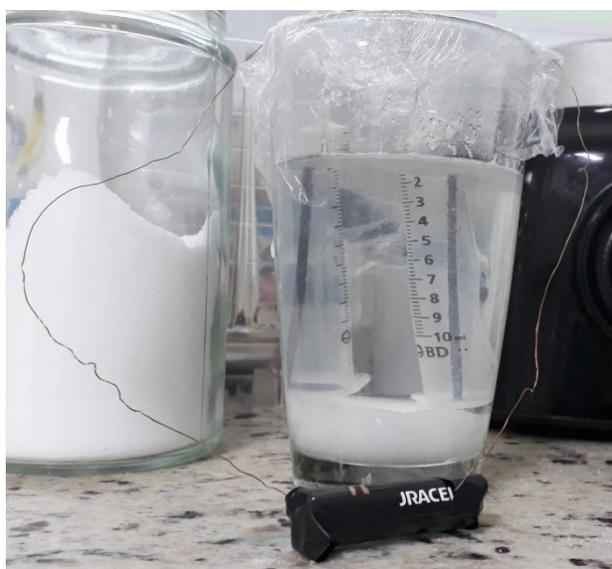
Figura 6: Montagem da célula eletrolítica
