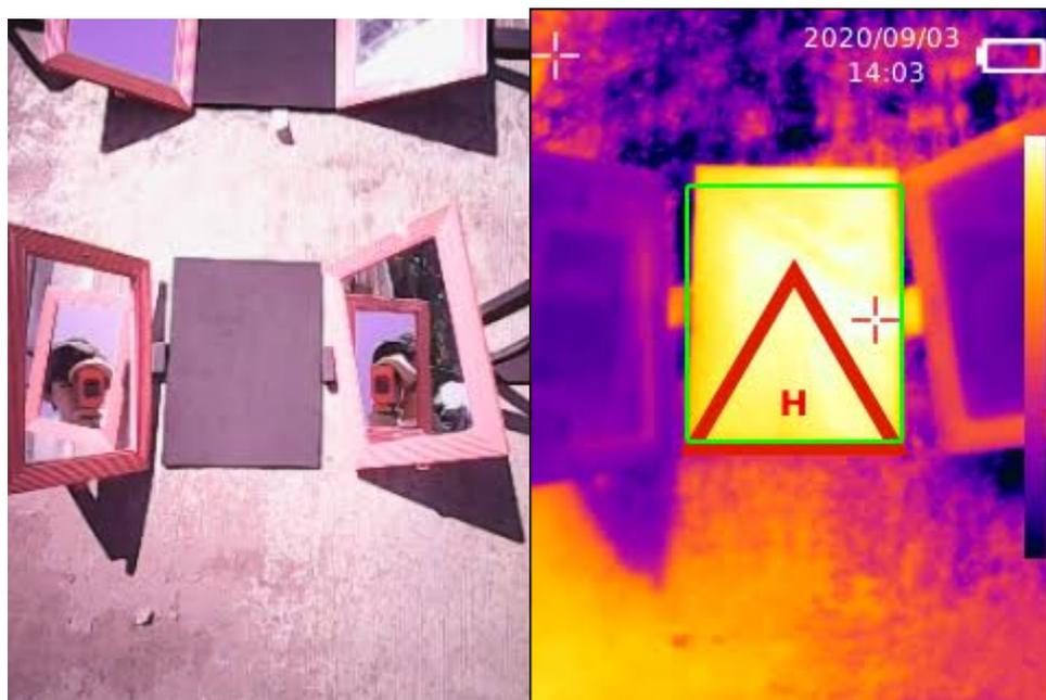
**Figuras 12 e 13: Espelhos posicionados a 60 graus do chão refletindo os raios solares, podemos perceber que os raios refletidos apresentam maior temperatura que 30 graus, porém menor que 40 graus (a imagem apresenta o alerta de temperaturas elevadas, porém não há um foco que mostra temperaturas muito altas).**
