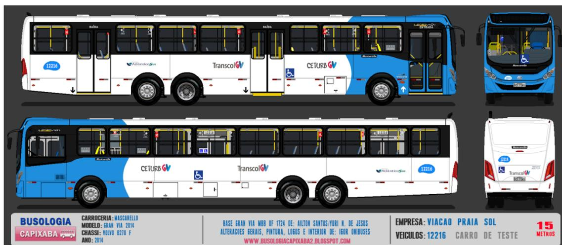
Figura 4 - Representação em desenho do Ônibus trucado Mascarello Gran Via sobre chassi Volvo B270F
