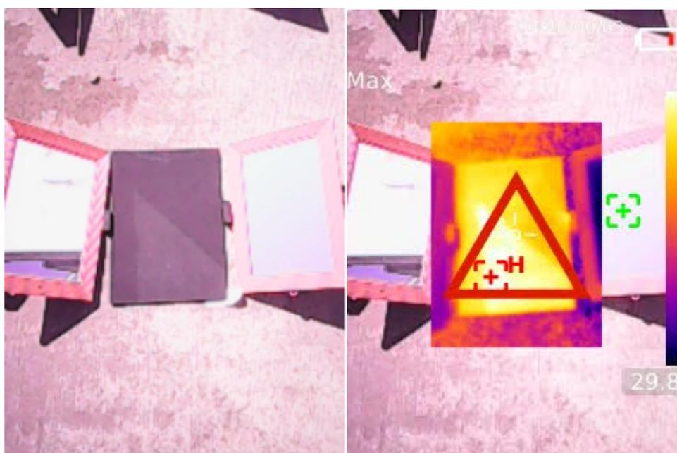
**Figuras 08 e 09: Espelhos posicionados a 40 graus do chão refletindo os raios solares no minuto 60 (a cruz vermelha mostra onde está localizada às temperaturas muito altas, e a verde, temperatura mais baixas. Já o triângulo H, é um alerta para temperaturas elevadas). A temperatura medida é de 70,8 graus Celsius.**
